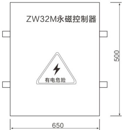
ZW32M-12控制箱外形及安装尺寸
